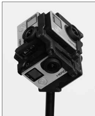
小型カメラを組み合わせたVR撮影用カメラ
