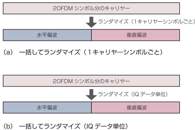
5図 変換テーブルを用いて一括して再配置する方法
