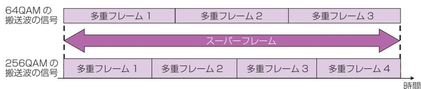
2図 64QAMと256QAMの信号の同期合成
