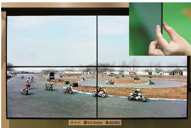
図1-3 高輝度、フレームレート120Hzの表示に対応したシート型有機ELディスプレイ
