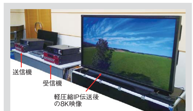
図1-18 軽圧縮8K IP伝送の室内実験
