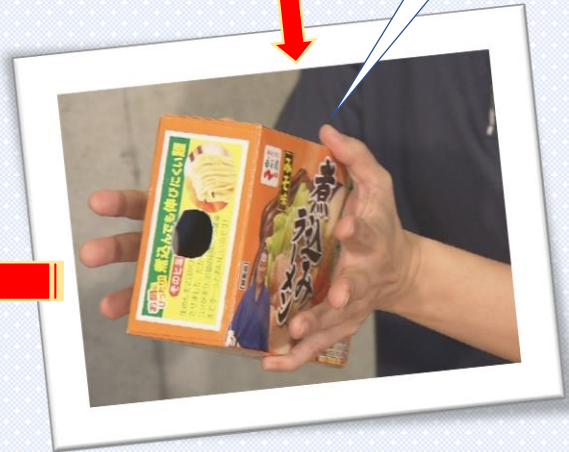
【②】 箱の隙間を目張りします 穴以外の隙間をテープで塞ぐ。
