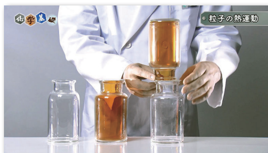
空気より重い二酸化窒素（褐色）を、空気が入ったびんの上または下にした状態でフタを外して実験
