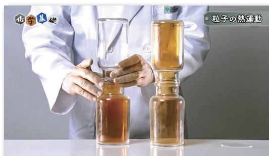
空気より重い二酸化窒素（褐色）を、空気が入ったびんの上または下にした状態でフタを外して実験
