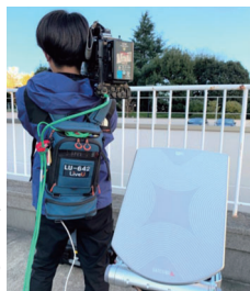
衛星IP伝送装置を使用した中継伝送 携帯電波圏外でも 中継・伝送が可能
