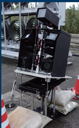
ロケット打ち上げ撮影用マルチカメラシステム
