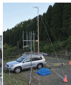
非常用送信車 (熊本地震における電波発射の様子)
