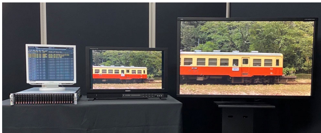
写真 1. 4K 映像と 8K 映像のマルチレイヤー符号化信号(ストリーム)を受信・復号して、4K と 8K のディスプレイに表示している様子(左の装置がデコーダー)
