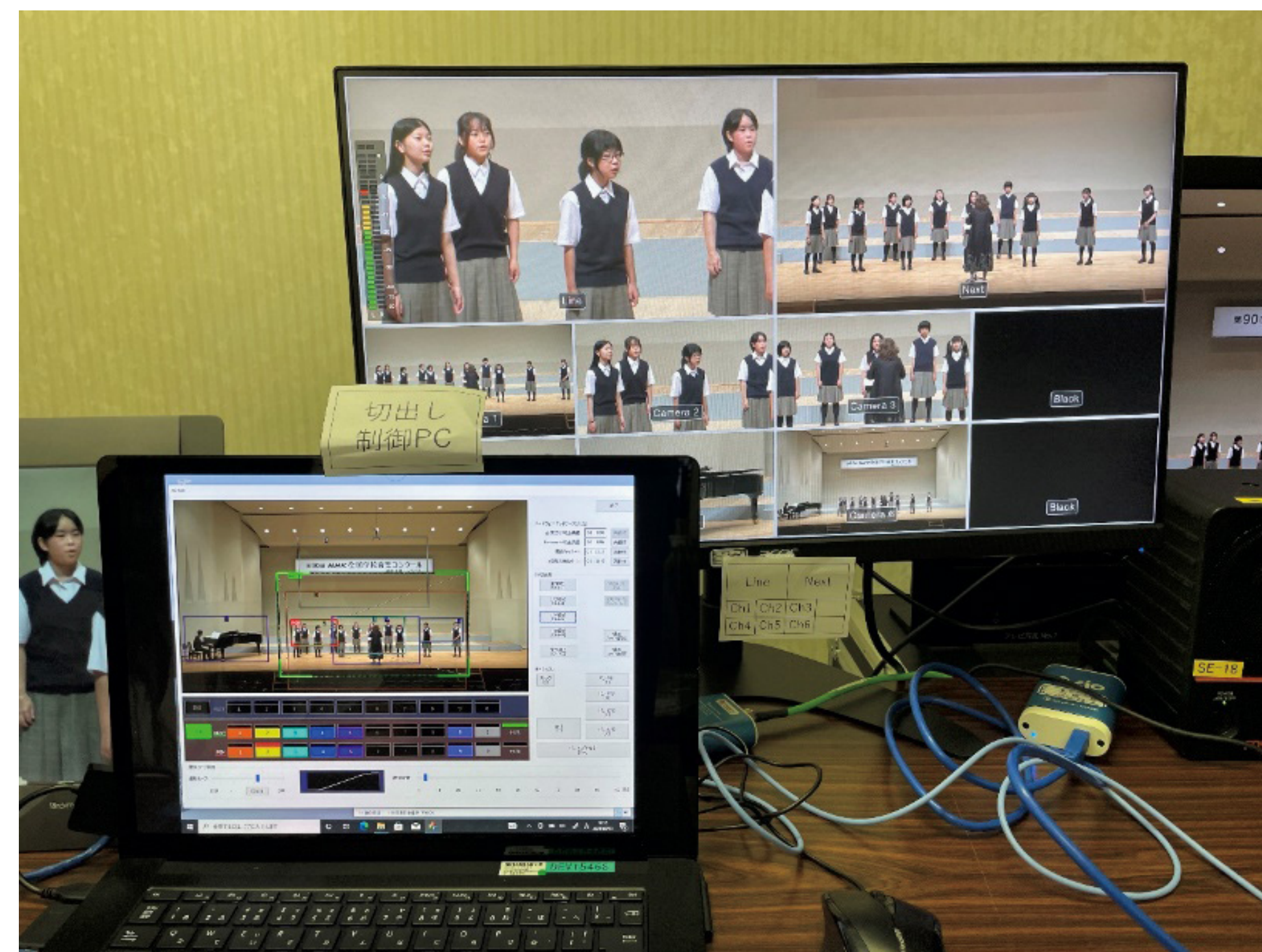
8K-ROI スイッチャー制作システムのオペレーション画面（左：制御端末）
