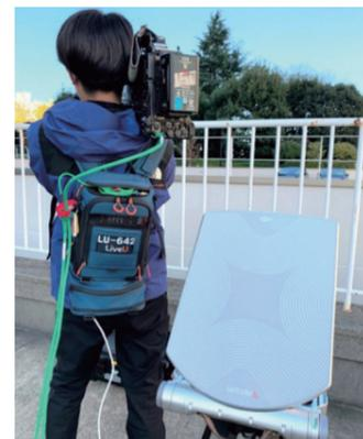
衛星IP伝送装置を使用した中継伝送
