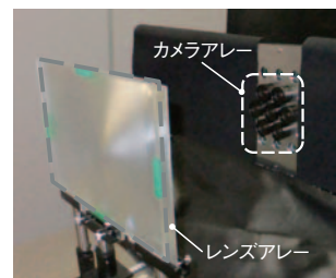
複数台のカメラを利用したインテグラル立体撮像システム
