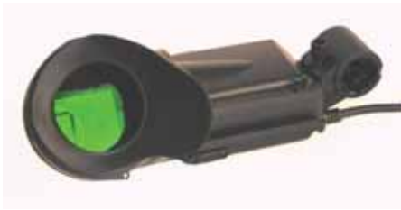
図 10.12 緑色蛍光体 SrGa 2 S 4 :Eu 薄膜を用いた CRT ビューファインダー (口絵参照)
