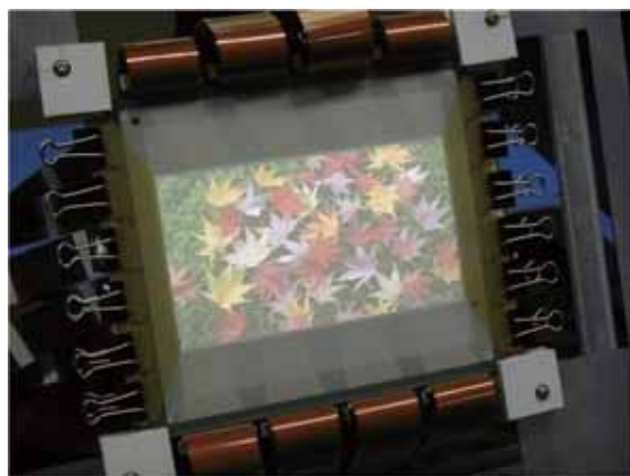
図 10.2 超高精細パネルによる画像表示 (対角 6.5 インチ、画素ピッチ 0.3 mm) (口絵参照)
