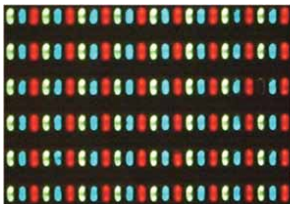
図 10.15 インクジェット法で形成した有機 EL 画素からの発光の様子
