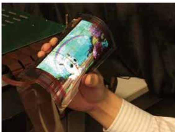
図 10.16 試作した対角 5.8 インチ Wide-QQVGA フレキシブル有機 EL ディスプレイ (口絵参照)
