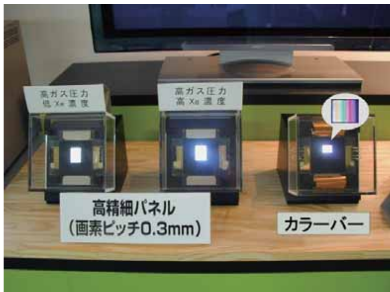
図 10.1 画素ピッチ 0.3 mm 高ガス圧力小型実験パネルによる白色およびカラーバー表示実験
