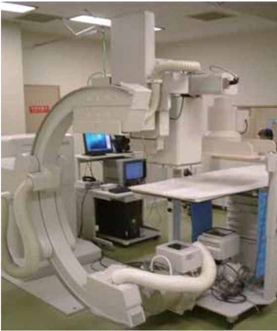
図 9.8 HARP カメラを用いた病院設置型微小血管診断装置 (国立循環器病センター提供)
