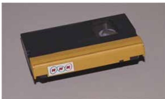
図 8.1 試作 6 mm 幅テープカセット
