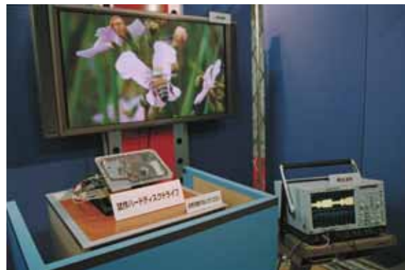
図 8.3 垂直磁気ハードディスク装置 (2004 年技研公開) (口絵参照)
