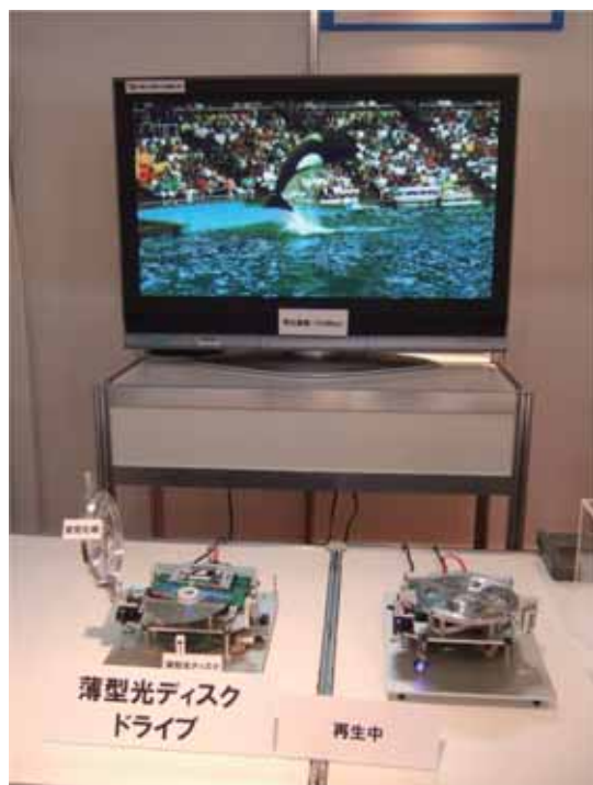
図8.11 試作薄型光ディスクドライブと再生画像(口絵参照)
