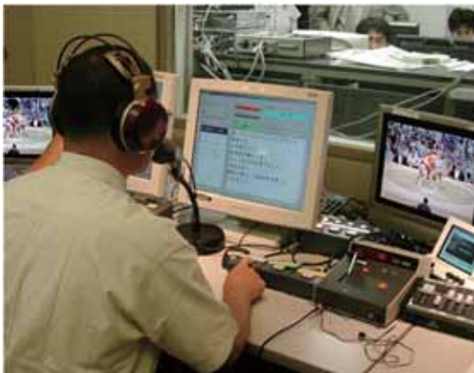
図 6.3 リスピーク方式の音声認識による生字幕制作システム (運用中) (口絵参照)
