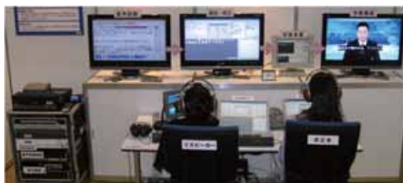
図6.2 ハイブリッド方式の音声認識によるニュース字幕制作(試作)
