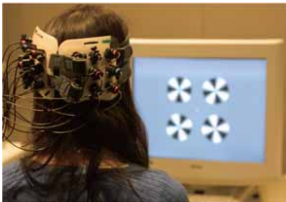
図 6.13 fNIRSを用いた脳活動計測実験
