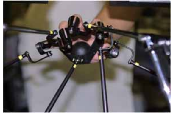
図 6.12 多指触力覚提示実験装置
