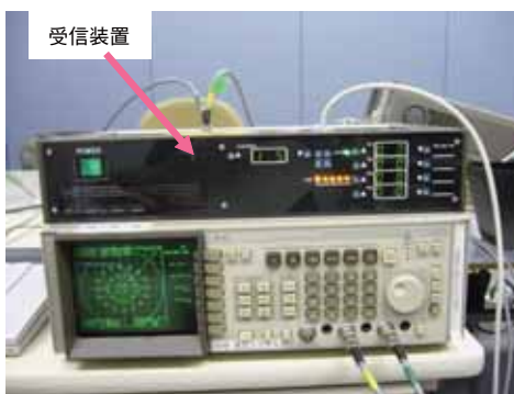
(b) 受信装置と32APSKのコンスタレーション
