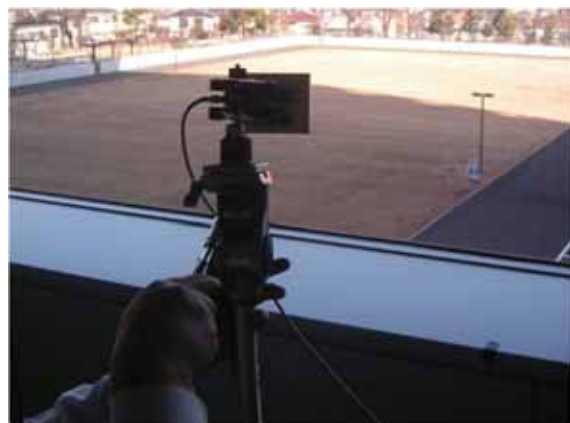
図3.24 光ファイバーとミリ波による屋外伝送
