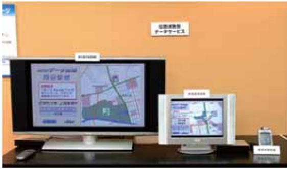
図 3.34 各種端末向け位置連動型データ放送サービス (口絵参照)
