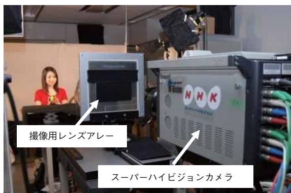
図 2.4 スーパーハイビジョンカメラを応用したインテグラル立体撮像の様子
