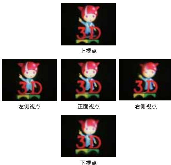
図 2.6 インテグラル立体テレビによる再生立体像 (観察者の視点位置に応じた立体映像が観察できる) (口絵参照)
