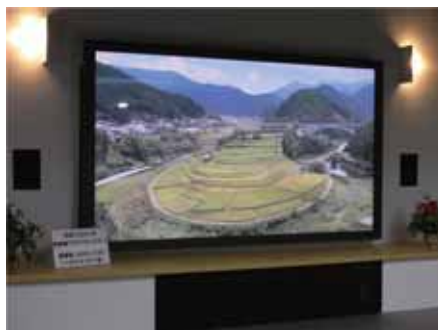
Quad HD高精細PDPによる画像表示 (対角103インチ、画素ピッチ0.59mm、図10.3)
