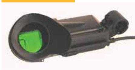
緑色蛍光体 \text{SrGa}_2\text{S}_4:\text{Eu} 薄膜を用いたCRTビュー ファインダー (図10.12)
