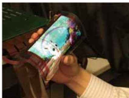
対角5.8インチWide-QQVGAフレキシブル 有機ELディスプレイ (図10.16)
