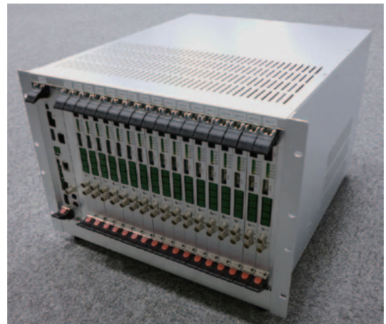
開発した8K・SHV対応HEVCリアルタイム符号化装置
