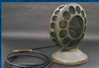
1927年、最初の野球中継で使用された形式のマイク (373型 ダブルボタンマイクロフォン)
