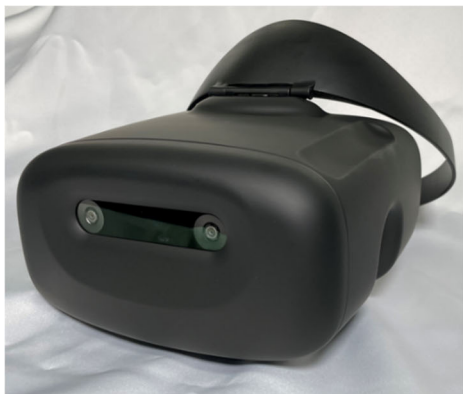
写真1. 開発したライトフィールド HMD
