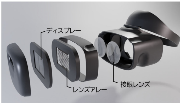
図1. ライトフィールド HMD の構成
