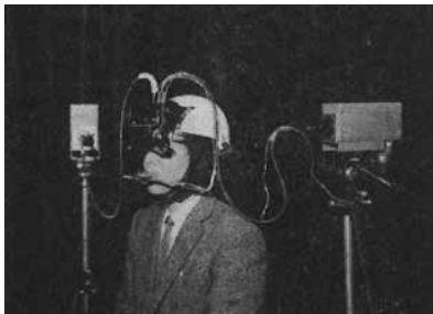
眼球運動測定装置（アイマーカー・カメラ） （1965年） （NHK放送技術研究所蔵）
