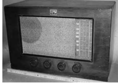
ビクター5AW-1型「黎明」5バンド5球スーパー 日本ビクター(株) 1946年 ビクターの戦後1号機のひとつ。
