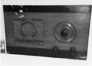
ナショナルR-1型 4球再生式 松下電器産業(株)無線製造所 1945年12月
