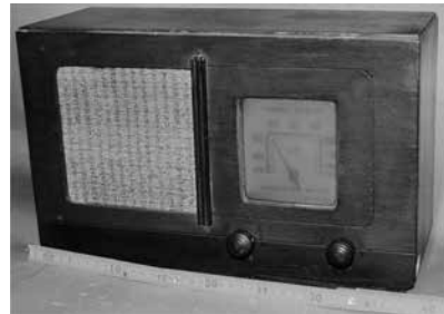
ナショナル4M-103型 国民型6号 松下電器産業（株）1947年 旧型真空管を使う国民型受信機。ラジオの大メーカーが多い関西で多く作られた。
